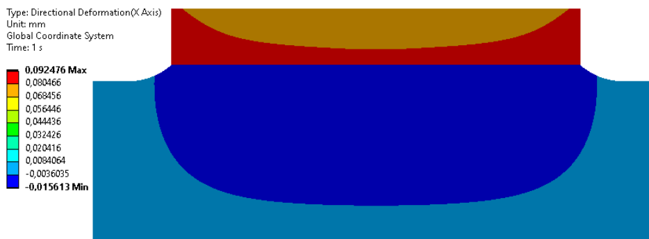
Rys. 12. Rozkład przemieszczeń promieniowych w przekroju wzdłużnym połączenia wciskowego – wariant W00
