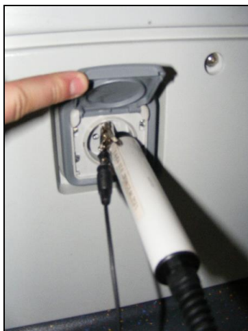
Fot. 2. Pomiary emisji przewodzonej portu 230 V AC sondą wysokonapięciową (fot. K. Ortel)
