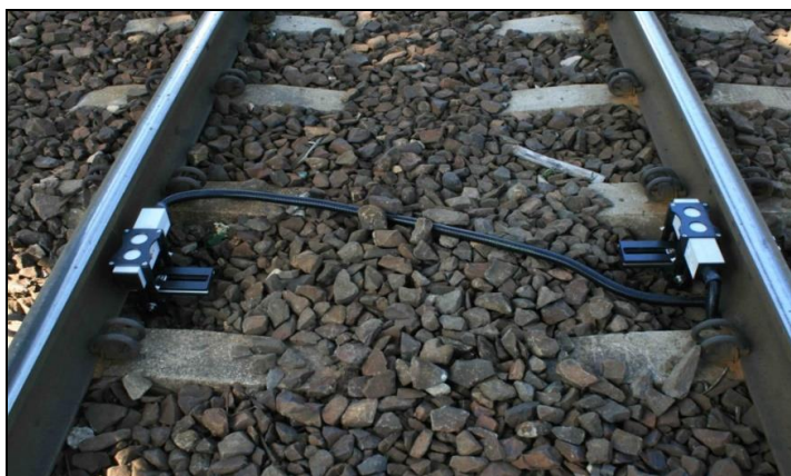
Fot. 4. Widok montażu anteny pomiarowej podczas pomiarów (fot. K. Ortel)
