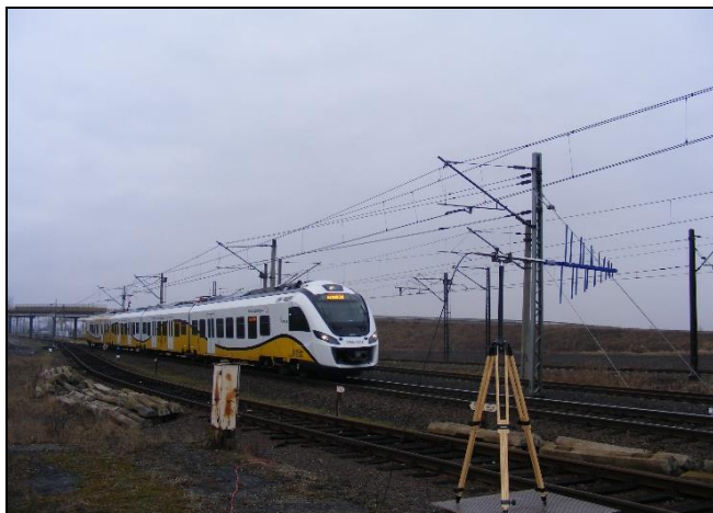
Fot. 1. Pomiary EMC anteną logarytmiczno-periodyczną na torze doświadczalnym Instytutu Kolejnictwa (fot. K. Ortel)
