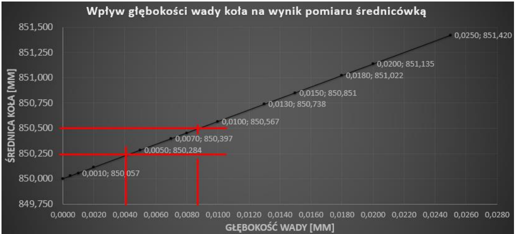
Rys. 4. Wykres zmian wskaźnika średnicy tocznicy D wynikający z lokalnej nierówności koła
