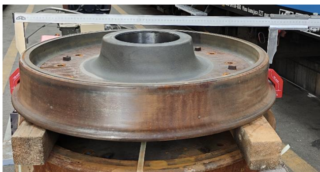
Rys. 7. Widok na pomiar suwmiarką noniuszową wraz z bazami pomiarowymi
